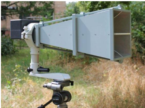
Фото 1. Антенна П6-126 на узле крепления АК-02
